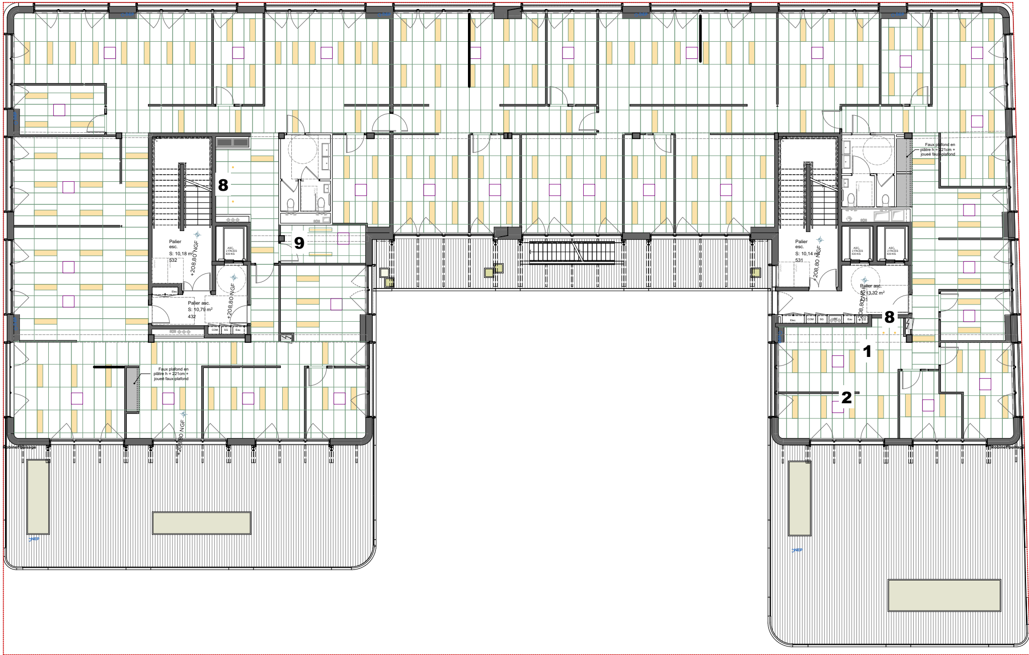
2 - LUMINAIRE Luminaire intégré au faux-plafond type PL CMFT 1200 P 33W 840 U19 DALIVR de chez LEDVANCE - calepinage au choix de l'architecte
